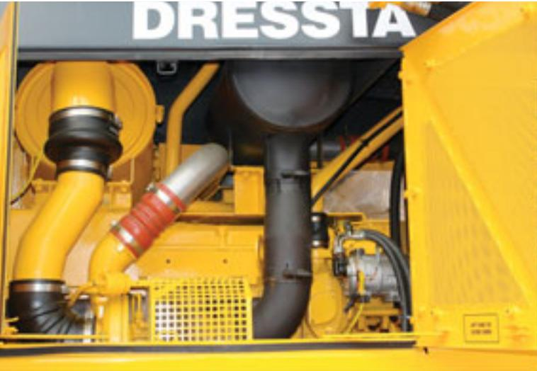
Надёжный и долговечный двигатель CUMMINS QSX15 соответствует требованиям норм по выхлопным газам Tier3, оборудован системой впрыска топлива под высоким давлением, электронной системой управления и изолированной, подкапотной системой выпуска выхлопных газов. Эти опции обеспечивают высокую надёжность, большую производительность и эффективную работу всей машины.
