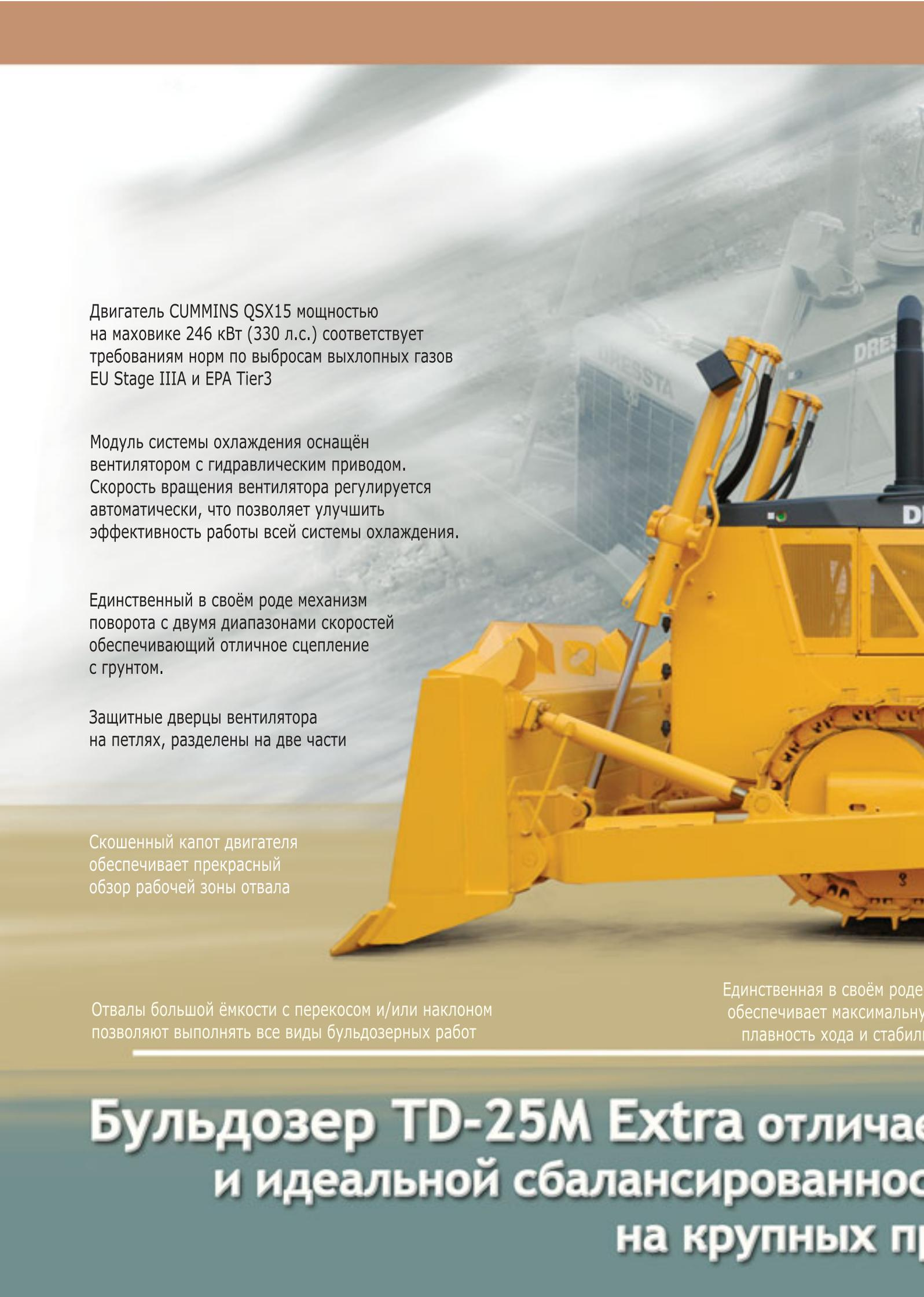
Двигатель CUMMINS QSX15 мощностью на маховике 246 кВт (330 л.с.) соответствует требованиям норм по выбросам выхлопных газов EU Stage IIIA и EPA Tier3
