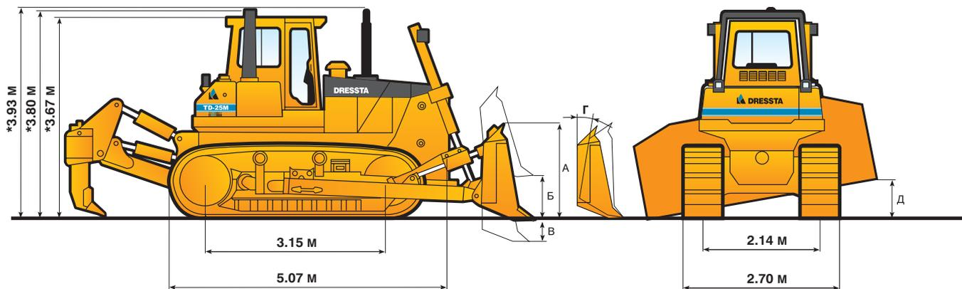
\*В РАЗМЕРАХ ОПРЕДЕЛЯЮЩИХ ВЫСОТУ, УЧТЕНЫ 76 мм ВЫСОТЫ ГРУНТОЗАЦЕПА.
