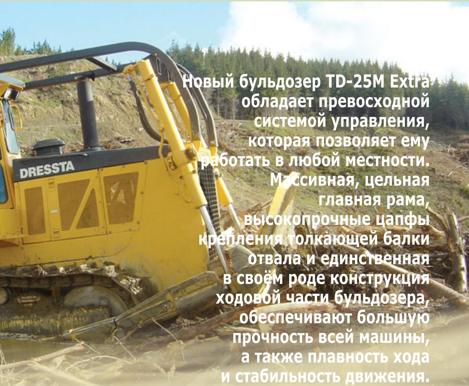
**Новый бульдозер TD-25M Extra обладает превосходной системой управления, которая позволяет ему работать в любой местности. Массивная, цельная главная рама, высокопрочные цапфы крепления толкающей балки отвала и единственная в своём роде конструкция ходовой части бульдозера, обеспечивают большую прочность всей машины, а также плавность хода и стабильность движения.**
