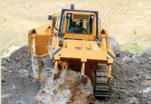
Джойстик эргономической конструкции обеспечивает отличное управление отвалом. Кнопки управления перекосом и наклоном отвала, точно регулируют положение отвала.
