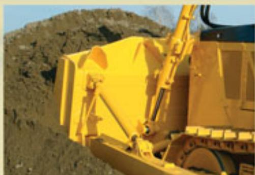
Для разных условий работы, бульдозер может комплектоваться разными типами отвалов: полусферическим, сферическим или угольным, а также перекосом и наклоном отвала.
