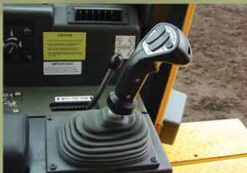
С помощью джойстика с левой стороны осуществляется переключение скоростей, направления движения бульдозера, переключение на высокий и низкий диапазоны и плавный поворот направо и налево. Предварительное включение передач с автоматическим включением пониженной передачи обеспечивают комфорт работы оператора и увеличенную производительность без необходимости включать пониженную скорость вручную.
