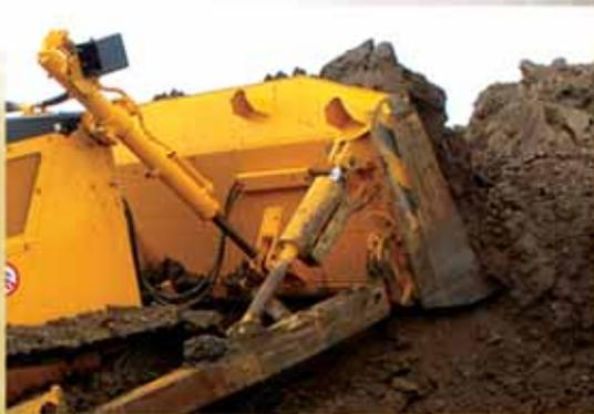
Отвалы типа „Semi-U“ ёмкостью 5,7 м<sup>3</sup> для модификаций (гусеничных рам) типа STD и LT, а также отвал ёмкостью 5,95 м<sup>3</sup> для модификации машины WT, сочетают в себе достоинства проникновения в грунт прямого отвала и увеличенную ёмкость благодаря боковым режущим кромкам отвала.
