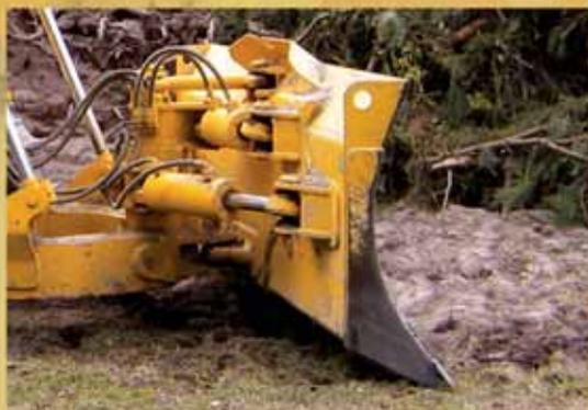
Отвал типа 6-way ёмкостью 3,8 м<sup>3</sup> в сочетании с широкой базой 2,03 м (WT) и с гусеницами шириной 560 мм применяется для различных работ, например для окончательного планирования территории, распределения материала на площадке и очистки территории от корней деревьев.
