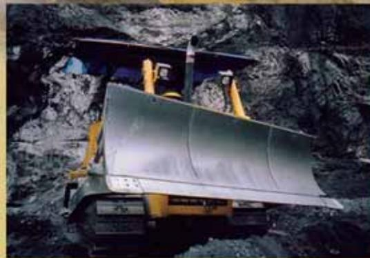
Угловой отвал ёмкостью 3,8 м<sup>3</sup>, применяемый на бульдозерах с гусеничными рамами типа STD и LT, очень хорошо справляется с такими работами как перемещение грунта в сторону, выравнивание неровностей, срезание краёв откосов и канав, окончательное планирование территории, что достигается при минимальном объёме передвижения машины на площадке, необходимым при такого рода работах. Перекос и наклон отвала с помощью 2-х гидроцилиндров предлагается как дополнительная опция.
