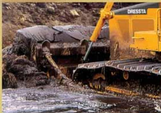
Прямой отвал ёмкостью 3,6 м<sup>3</sup>, на машине с гусеничной базой 2,16 м и башмаками гусениц шириной 940 мм (LGP), предназначен для работы в мягкой болотистой местности. Данный отвал может быть укомплектован гидравлическим цилиндром перекоса для эффективной работы.
